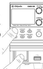
2. 電源投入時設定にて、F-93(マスタ・スレーブ設定)をそれぞれの機器に対して設定します。
